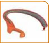
Moldex3D Co-Injection은 Skin과 Core의 연속 사출 과정을 시각화 합니다. 이를 통해 두 재료의 최적 조합을 위해 재료를 결정 할 수 있습니다. Moldex3D는 높은 온도나 스트레스에 의한 잠재적 결함 영역을 확인하는 것과 부품 표면에 잠재적 breakthrough를 예측 할 수 있게 도와줍니다.
