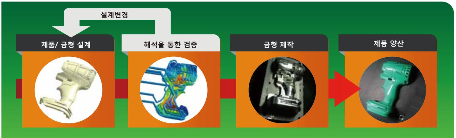
이제는 이처럼 비효율적인 것로부터 벗어나 발전해 나가야 합니다. Moldex3D 솔루션은 사용자가 시행착오를 겪기 전에 제품과 금형 디자인을 시뮬레이션 하고 검증하는 것을 도와줍니다. 주요한 제품 결함은 미리 예측되어질 수 있고, 디자인 수정 및 최적화는 설계 초기 단계에서 훨씬 더 빠르고 쉽게 수행할 수 있습니다. Moldex3D는 금전 및 노동적인 수고 뿐만 아니라 시간이 많이 드는 금형 수정 시간을 단축해 줍니다.
