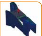
Moldex3D MuCell®은 수지 충전 시 발포 및 셀의 성장을 시뮬레이션 합니다. 마이크로 셀룰러 수, 밀도 분포, 체적 수축 등을 보여 줍니다. 사용자는 보압 시 수축 보정을 관찰 할 수 있고, 힘 변형 결과를 예측 할 수 있습니다. Moldex3D는 더 효과적으로 최적 사출 조건을 결정하고, 제품 결함을 줄일 수 있게 도와 줍니다.
