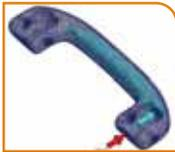
Moldex3D GAIM/WAIM 은 대형 TV 캐비닛, 핸들 또는 분할 파이프와 같은 빈 플라스틱 부품의 가스 또는 물 사출 성형 공정을 역학적으로 시뮬레이션 합니다. 금형 캐비티 내부의 가스/유체 침투 행동의 3D 시각화를 통해 사용자는 Core-out, sink mark 그리고 변형 문제를 확인 할 수 있습니다. 오버 플로우 영역을 정의하고 금형 설계 및 공정 조건을 최적화 할 수 있습니다.
